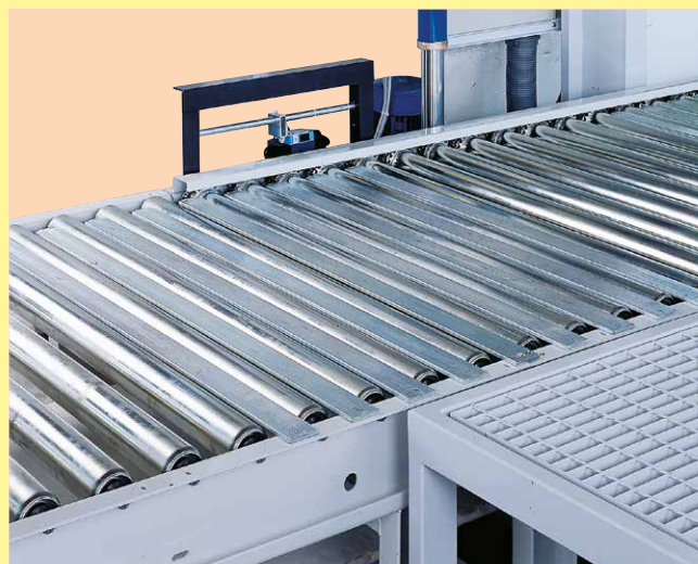
Transportador de rodillos (transitable).
